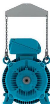
Figura 10 - Uso de barra separadora no içamento
