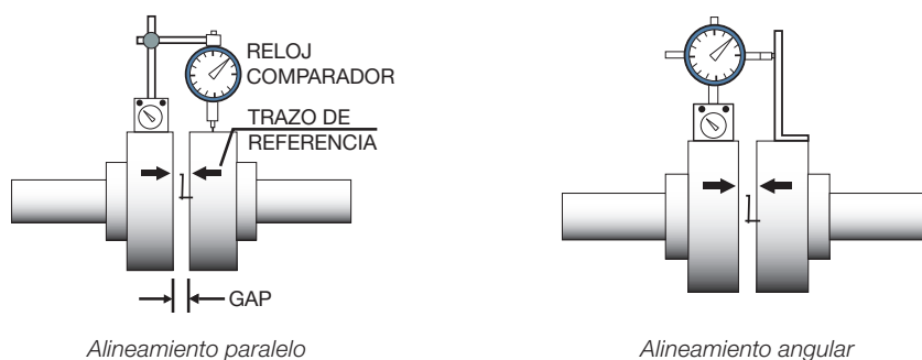
Figura 42 - Alineamiento con reloj comparador
