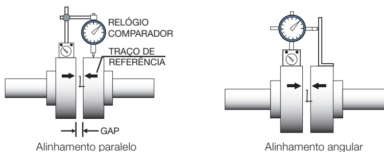
Figura 42 - Alinhamento com relógio comparador
