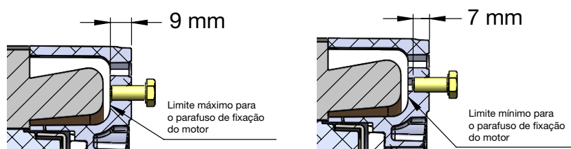
Figura 38 - Límite de profundidad del engaste
